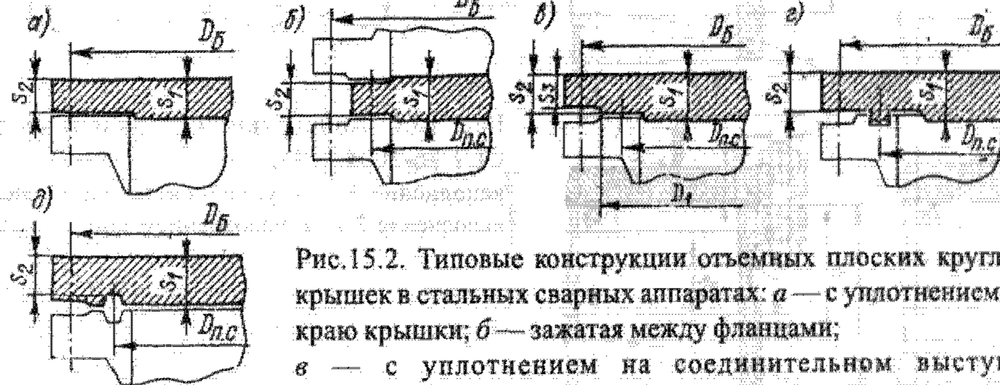
Рис.15.2. Типовые конструкции отъемных плоских круглых крышек в стальных сварных аппаратах: а — с уплотнением по краю крышки; б — зажатая между фланцами; в — с уплотнением на соединительном выступе; г — с уплотнением выступ — впадина или шип — паз; д — с уплотнением овальной или восьмиугольной прокладкой
